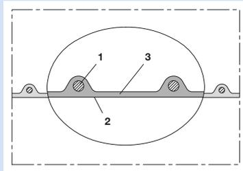
Antistatischer Lebensmittelschlauch und Pharmaschlauch, mittelschwer und verstärkt, Edelstahlhrah (INOX)
