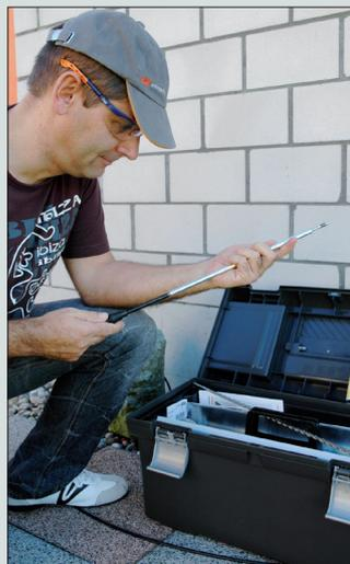
**2.** Drehen Sie das Befestigungssystem in das Einschlagwerkzeug ein.
