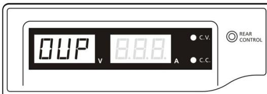
Zum Zurücksetzen der Warmmeldung schalten Sie das Gerät aus und entfernen Sie alle Lasten. Schalten Sie das Gerät wieder ein. Das Gerät nimmt den normalen Betrieb wieder auf. Bleibt das Problem bestehen, wenden Sie sich bitte an Ihren Fachhändler.
