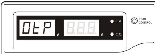
Überprüfen Sie die Last und die Ausgangsleistung. Lassen Sie das Gerät mindestens 30 Minuten abkühlen. Prüfen Sie, ob die Lüftung blockiert ist und genug Raum um das Netzgerät ist. Achten Sie auf Windgeräusche des Lüfters, wenn Sie das Gerät wieder einschalten. Wenn Sie beim Einschalten diese routinemäßigen Windgeräusche des Selbsttests nicht hören, könnte der Lüfter defekt sein. Benutzen Sie das Netzgerät nicht und wenden Sie sich an Ihren Fachhändler.
