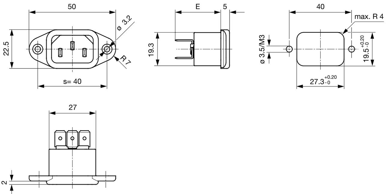
E: Steckanschlüsse 4.8x0.8 mm: 25.3 mm
