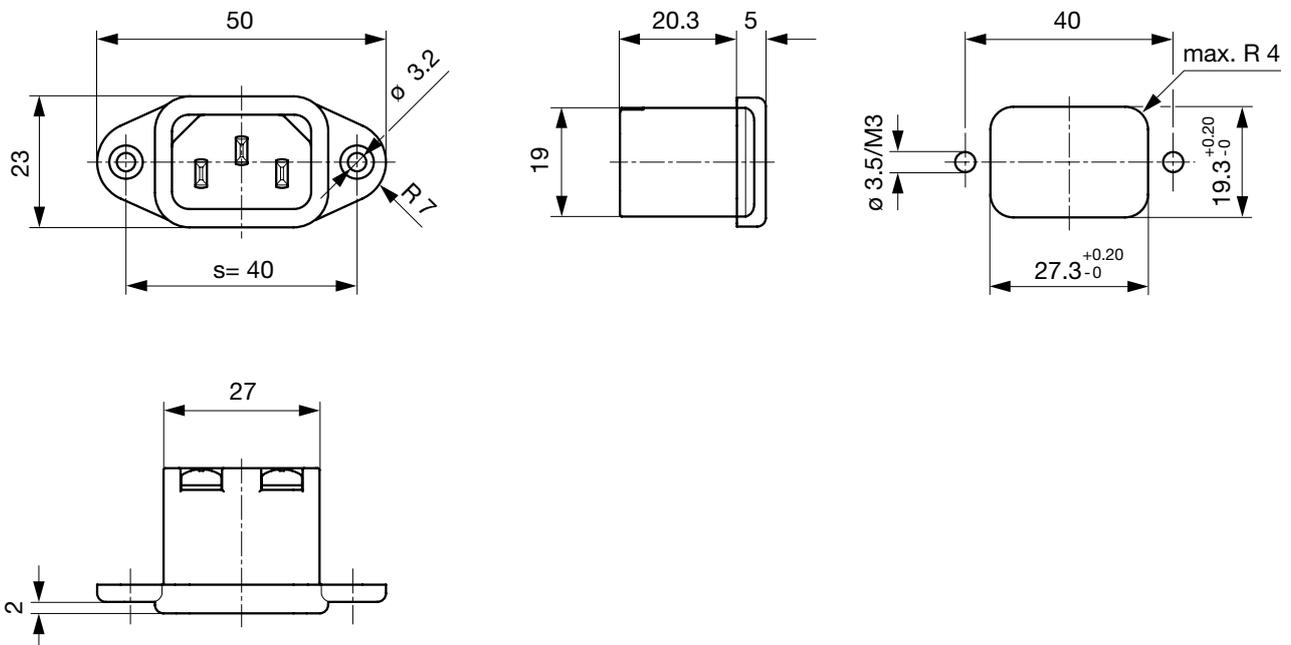
Schutzklasse II, Senkloch-Montagelöcher, 40 mm Abstand, Steck- und Lötanschlüsse
