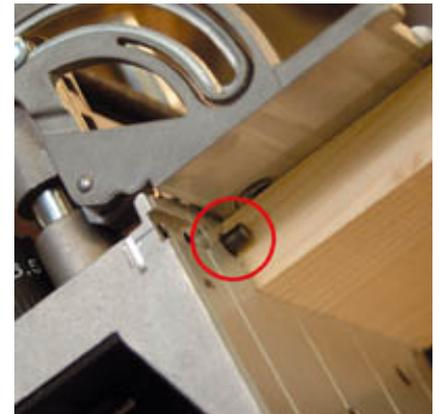
Versenkbare Anschlagstifte für randnahe Bohrungen ohne Anriss.
