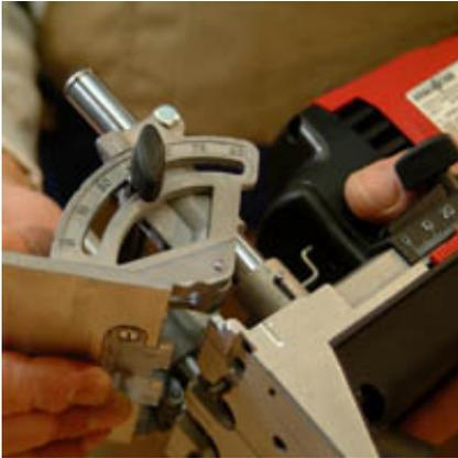
Einstellungen für Materialstärke, Schwenkanschlag und Bohrtiefe stufenlos möglich.
