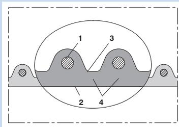
Elektrisch leitfähiger Polyurethanschlauch, superschwer
