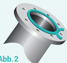
2.1. c Schließen des Dichtungsbandes
