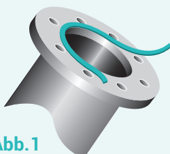
2.1. b Anbringen des Dichtungsbandes
