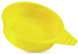
Die ECO-Griffstopfen GPN 480 sind als Kappe oder Stopfen anwendbar und schützen Außengewinde, Bolzen und Leitungen und Innengewinde und Bohrungen. Beim thermogeformten Griffstopfen reduziert sich der Materialeinsatz um bis zu 70 %. Das stapelbare Design führt zu einer Reduzierung des Transport- und Lagervolumens um bis zu 75 %. Die Grifffläche ermöglicht eine sehr schnelle Demontage.
