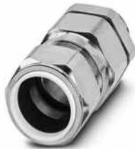
Kabelverschraubung, Material Verschraubung: Messing, vernickelt, Anwendung: Ex, Kabelaußendurchmesser 9,5 mm ... 15,9 mm, Schirmung: ja, Anschlussgewinde: M20 x 1,5, Farbe: silberfarben
