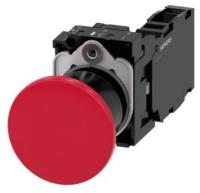
Pilzdrucktaster, 22 mm, rund, Kunststoff, rot, 40 mm, verrastend, Zugentriegelung, mit Halter, 1S+1Ö, Schraubanschluss
