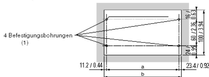
(1) Der Durchmesser der Befestigungsbohrungen muss für Schrauben M4, M5, M6 und UNC Nr. 6 passen.
