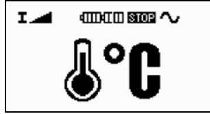
Bild 3.11 Hinweis auf hohe Temperatur nach Drücken von START
