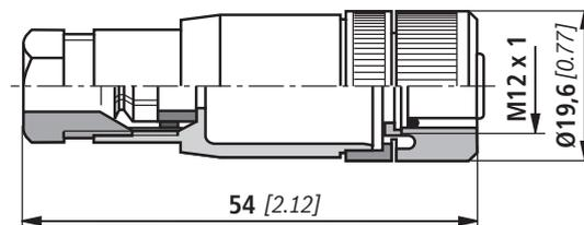
**Leitungsdose passend zu K24-3m 4-polig, M12 x 1
