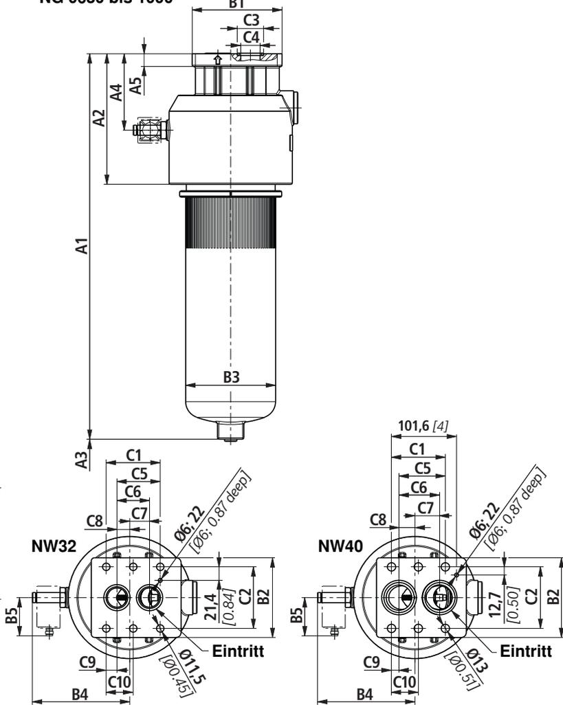
**Filtergehäuse für Filterelemente nach DIN 24550 und nach BR Standard**
