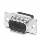
D-SUB-Kontakträger, Shell-Größe 1, für 15 Signalkontakte, Kontaktart Stift, für Crimpkontakte, gerade, Befestigung mittels Bohrung 3 mm, für Anbaurahmen und Tüllengehäuse VS-09-...
