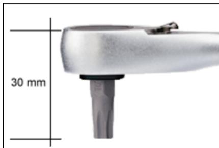
Für die Aufnahme von 1/4"-Standardbits. Mit Magneteinsatz. Distanz von Umschalthebel bis zur Bit-Spitze nur 30 mm. Feinverzahnt: Mehrere der 72 Zähne rasten gleichzeitig ein und übertragen hohes Drehmoment. Umschalthebel für Rechts- und Linkslauf. Entriegelungs-Mechanismus: Lösen der Einsätze durch Knopfdruck. Aus CrV-Stahl geschmiedet, 2x vernickelt und matt-verchromt. Griff aus öl- und säurefestem TPR (Thermoplastic Rubber). Mit praktischer Bohrung zum Aufhängen.
