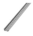
Tragschiene gelocht, nach EN 60715, Material: Stahl, verzinkt, weiß-passiviert, Standardprofil, Farbe: silberfarben, Verpackungsvariante mit 25 Stück (50 m)
