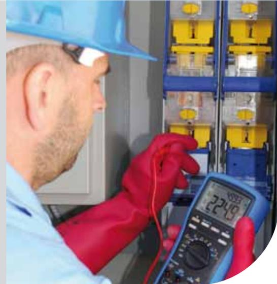
Das MD 9060 gehört mit großer Bandbreite und sehr hoher Auflösung zu den genauesten Multimetern. Das Metrel MD 9060 ist mit einer integrierten Frequenzumrichterfunktion für die Messung wahrer Werte in Abhängigkeit von der Frequenz ausgestattet. Weitere Merkmale sind ein großes zweizeiliges LC-Display bis 500.000, schnelle Datenerfassung und -übertragung (über optische Schnittstelle), CAT IV / 1000 V, Strom- und Spannungsmessung TRMS, Leitfähigkeitsmessung und schnelle Einhandbedienung.
