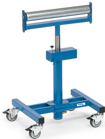
Zur Unterstützung von Langmaterialien an Sägen, Pressen Bohrmaschinen usw. Stufenlos höhenverstellbar, dreh- und arretierbar, mit pneumatischer Absenkämpfung. Fahrbar. Auflagerolle aus Stahlrohr 60 mm ø, 450 mm breit, kugelgelagert. Beidseitig Schwerkraftanschläge 20 mm über Oberkante Rolle (drehen sich bei breiten Werkstücken selbsttätig weg). 4 Lenkrollen mit Feststeller.
