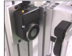
Abb. 3: gelbes Licht signalisiert Schutztür offen.
