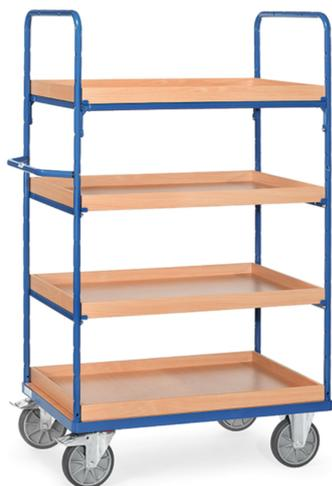
Ensemble mécano-soudé, revêtement époxy bleu RAL 5007. 1 caissette fixe et 3 amovibles en mélaminé surface effet hêtre. Caissettes amovibles réglables au pas de 100 mm. Charge maximum par caissette : 120 kg. 2 roues pivotantes et 2 roues fixes à bandage TPE, moyeu à roulement à roulement à billes central. Freins sur roues pivotantes conformément à la Norme EN 1757-3 (Sécurité des chariots de manutention).
