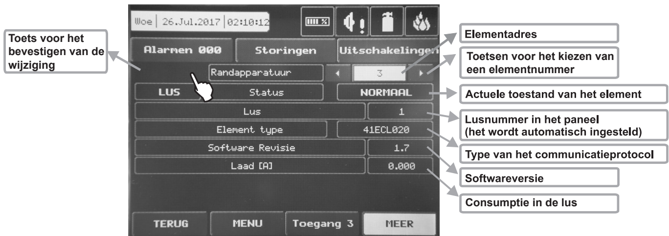
Figuur display 7 – LUS (Luscontroller) – Voorbeeld voor het toevoegen van een randapparaat Lus COMELIT 41ECL020.
