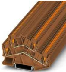
Doppelstockklemme, Nennspannung: 500 V, Nennstrom: 22 A, Anschlussart: Push-in-Anschluss, 1. und 2. Etage, Bemessungsquerschnitt: 2,5 mm<sup>2</sup>, Querschnitt: 0,14 mm<sup>2</sup> - 4 mm<sup>2</sup>, Montageart: NS 35/7,5, NS 35/15, Farbe: braun
