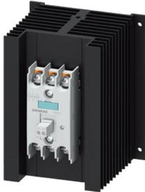
Halbleiterschütz 3-phasig 3RF2 AC 51 / 50 A / 40 °C 48-600 V / DC 4-30 V 3-Phasengesteuert Ringkabelanschluss Sperrspannung 1200 V
