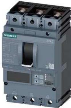
Leistungsschalter 3VA2 IEC Frame 160 Schaltvermögenklasse C Icu=110kA @ 415V 3-polig, Anlagenschutz ETU560, LSIG, In=25A Überlastschutz Ir=10A...25A Kurzschlusschutz Isd=0,6..10x In, li=1,5..12x In N-Leiterschutz optional mit externem Stromwandler, bis 160% Erdschlussschutz, abschaltbar Ig=0,2...1 x In, tg=0,05-0,8s Schraubenflachanschluss
