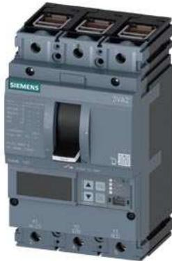
Leistungsschalter 3VA2 IEC Frame 160 Schaltvermögenklasse C Icu=110kA @ 415V 3-polig, Anlagenschutz ETU850, LSI, In=25A Überlastschutz Ir=10A...25A Kurzschlusschutz Isd=0,6..10x In, li=1,5..12x In N-Leiterschutz optional mit externem Stromwandler, bis 160% Klemmenanschluss
