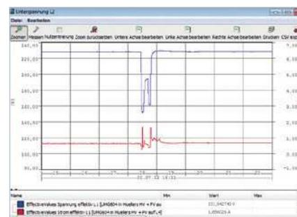
Abb.: Der Ereignisbrowser gibt einen schnellen Überblick über Spannungseinbrüche mit Datum- und Zeitstempel sowie Länge und Tiefe des Spannungseinbruchs.
