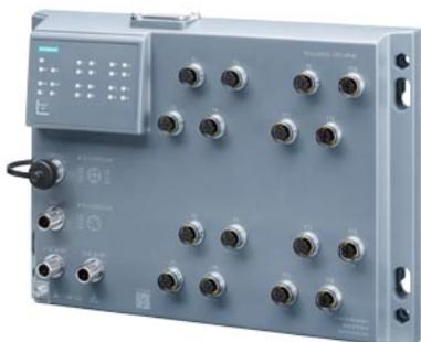
SCALANCE XP216 (EIP), managed IE Switch, 12x 10/100 Mbit/s IEC 62443-4-2 zertifiziert; M12 Ports, 4x 10/100/1000 Mbit/s M12 Ports IP65, LED-Diagnose, Fehler-Meldekontakt, redundante Spannungsversorgung, Ethernet/IP, Netzwerk-Management, inkl. Staubschutzkappen, inkl. elektron. Handbuch auf CD-ROM, C-PLUG optional.
