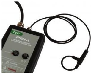
Die CWTMini50HF ist für schneller schaltende Anwendungen wie z.B. SiC optimiert und verfügt über eine Hochfrequenzbandbreite (-3 dB) von 50 MHz mit einer geschirmten 100-mm-Spule bei nur 3,5 mm Dicke (2 kV Spitzenisolierung).
