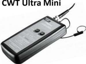
Die CWT Ultra Mini-Reihe verfügt über die kleinste Rogowski-Spule auf dem Markt, welche trotzdem über eine Bandbreite von 30MHz (-3dB) verfügt. Der Spulenquerschnitt von 1,7 mm ermöglicht die Anwendung z.B. zwischen Beinen eines Halbleiterbauelements.
