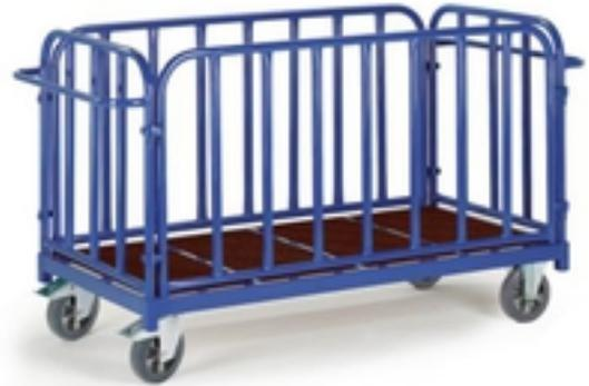
Ladefläche aus rutsch- und wetterfester Siebdruckplatte. Längswände an Stirnwände einhängbar. Schiebegriff aus Stahlrohr: a'Ëœ 26,9 x 1,75 mm. Pulverbeschichtung in Enzianblau (RAL 5010). Ladefläche: 1300 x 800 mm
