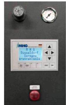
Schaltschrank Typ Rittal am Maschinenkorpus montiert, mit Micro SPS Typ SIEMENS Logo, Motorschutzschalter, Sicherheitsrelais ausbaufähig für weitere Sonderfunktionen.
