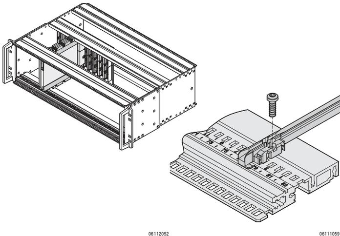
Führungsschienen bilden die Schnittstelle zwischen der Baugruppenträger-Mechanik und den Baugruppen (Leiterplatten, Steckbaugruppen, Kassetten, Laufwerkassetten, ...). Stabile Schnapphaken an den Kunststoffschienen gewährleisten einen sicheren Halt, auch bei Erschütterungen. Die Führungsschienen können bei Typ Heavy und Typ Rugged zusätzlich angeschraubt werden.
