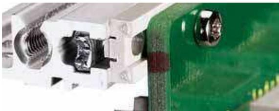
Modulschiene hinten zur Backplanemontage mit Isolierstreifen
