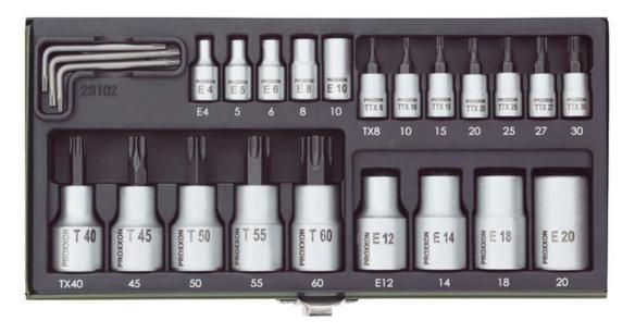
TX-Schraubereinsätze für 1/4"-Antrieb (6,3 mm) von Gr. TX 8 bis TX 30 (mit stirnseitiger Bohrung) und Außen-TX Gr. E 4 bis E 10 (alles Anzugsdrehmomente bis 25 Nm).
