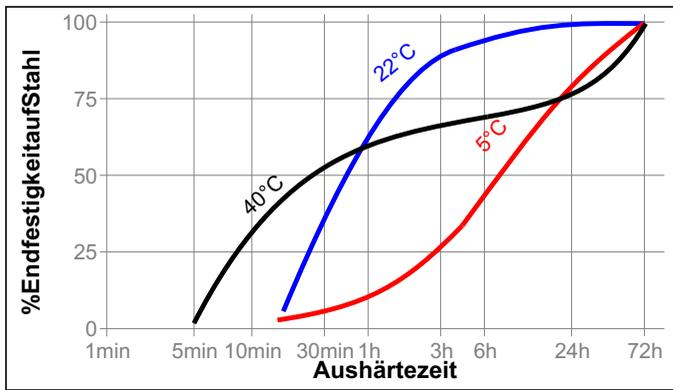
**Aushärtegeschwindigkeit in Abhängigkeit vom Aktivator**
