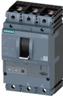
Leistungsschalter 3VA2 IEC Frame 100 Schaltvermögenklasse H Icu=85kA @ 415V 3-polig, Anlagenschutz ETU320, LI, In=63A Überlastschutz Ir=25A...63A Kurzschlusschutz Ii=1,5...12 x In Schraubenflachanschluss
