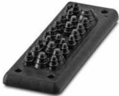
Kabeldurchführungsplatte, Anzahl der Leitungen: 25, Leitungsaußendurchmesser: 3x 3 mm ... 6 mm, 9x 3 mm ... 7 mm, 8x 6 mm ... 9 mm, 4x 6 mm ... 12 mm, 1x 10 mm ... 20 mm, Material: PP (Kern), Material: TPE-SEBS (außenliegendes Material), Farbe: schwarz, Länge: 154 mm, Breite: 56 mm, Höhe: 20 mm
