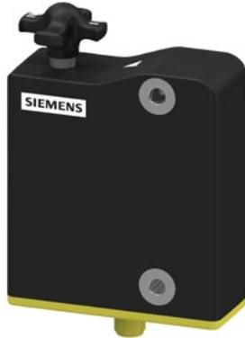
RFID-Sicherheitsschalter mit Zuhaltung, Kunststoff, Ruhestromprinzip, Zuhaltung- Überwachung, 24V DC, mit Hilfsentriegelung, IP69, Zuhaltekraft 1150 N, familiencodiert, Diagnoseausgang, M12 Stecker 8-polig, 3 LEDs zur Anzeige der Betriebszustände, 3 Betätigungsrichtungen, Rastkraft mit Drehkreuz verstellbar: 25 N oder 50 N. Hygienegerechtes Design. Betätiger 3SE6410-1AC01 separat bestellen.
