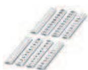
Nastro Zack piatto, Striscia, bianco, siglato, siglatura trasversale: numeri progressivi 1-10, 11-20 ecc. fino a 91-100, Tipo di montaggio: Inserimento a scatto in scanalatura piatta portacartellini, per morsetti con spessore: 5 mm, Dimensioni campo di siglatura: 5,15 x 5,15 mm
