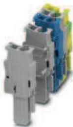
Maschio, Collegamento: Connessione a molla, N. poli: 1, Sezione: 0,08 mm<sup>2</sup> - 4 mm<sup>2</sup>, AWG: 28 - 12, Larghezza: 5,2 mm, Altezza: 39 mm, Colore: grigio
