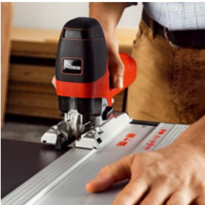
Für exakt gerade Schnitte lässt sich die P1 cc mit der MAFELL Führungsschiene F kombinieren.
