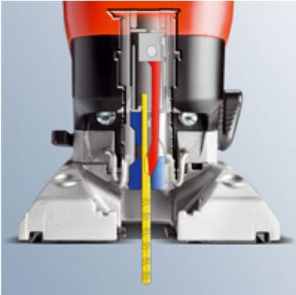
Bei der neuartigen CUmax Sägeblattspannung drückt ein Keil das Sägeblatt in den Formschluss. Das Sägeblatt sitzt dadurch unverrückbar fest.
