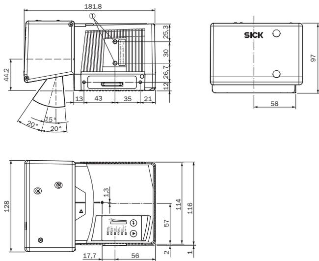
① Sacklochgewinde M6, 7 mm tief (2 x), zur Befestigung
