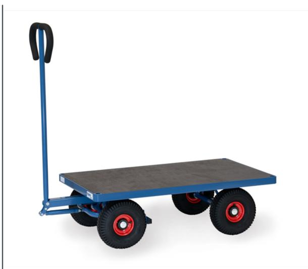
En tube d'acier soudé, revêtement époxy bleu RAL 5007. plateau en contreplaqué hydrofuge. Essieu avec timon. Roues gonflables, moyeu à roulement à rouleaux. Poignée sécurisée avec revêtement souple remontant automatiquement en position verticale. Blocage automatique de l'essieu avant, conformément à la Norme EN 1757-3.
