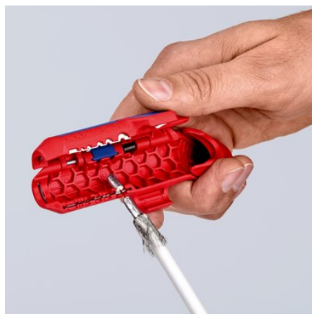
Usuwanie izolacji z kabli koncentrycznych
