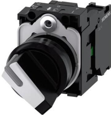
Knebelschalter, beleuchtbar, 22 mm, rund, Kunststoff, weiß, Knebel, kurz, 2 Schaltstellungen O-I, verrastend, 10:30h/13:30h, mit Halter, 1S, Schraubanschluss
