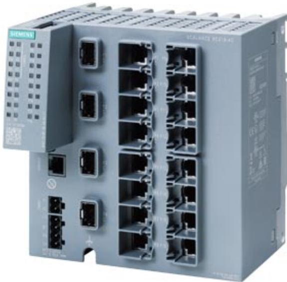
SIPLUS NET SCALANCE XC216-4C -40...+70°C mit Conformal Coating based on 6GK5216-4BS00-2AC2 . managebarer Layer 2 IE Switch; 12x 10/100 Mbit/s RJ45-Ports; 4x 1000 Mbit/s Comboports (Entweder 1000 Mbit s SFPs oder 10/100/1000 Mbit/s RJ45 Ports nutzbar); 1xKonsolen-Port; Diagnose-LED; redundante Spannungsversorgung Temp.-Bereich-40°C bis +70°C; Montage:Hut-/S7-Profileschiene/ Wand;Redundanzfunktionen; OfficeFeatures(RSTP,VLAN,...); PROFINET IO-Device;Ethernet/ IP-konform;C-PLUG Schacht;
