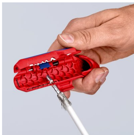
Pelar un cable coaxial
