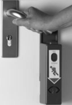
Beim Durchdrücken der Türklinke verschiebt sich der EH-Türwächter automatisch nach unten und ermöglicht in einem Öffnungsvorgang das Begehen der Notausgangstür. Dabei wird Daueralarm ausgelöst, der nur mit dem Geräteschlüssel gelöscht werden kann.
