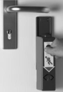
Mit dem Geräteschlüssel kann der Türwächter durch Verschieben nach unten alarmfrei in eine Dauerfreigabeposition gebracht werden. In dieser Position ist die Tür normal begehbar. Ein Daueroffenkontakt ist auf Wunsch möglich.
