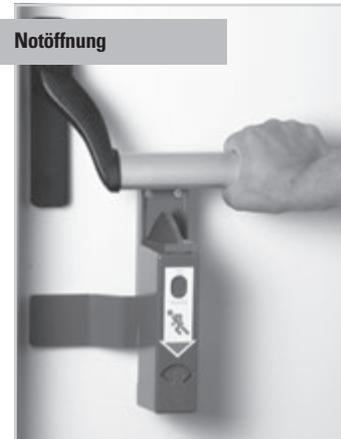
Beim Durchdrücken des Stangengriffes verschiebt sich der EH-Türwächter automatisch nach unten und ermöglicht in nur einem Öffnungsvorgang das Begehen der Notausgangstür. Dabei wird Daueralarm ausgelöst, der nur mit dem Geräteschlüssel gelöscht werden kann.
