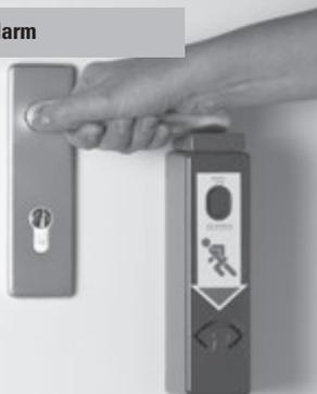
Bei leichtem Drücken der Türklinke ertönt Alarm. Sobald die Klinke losgelassen wird, verstummt der Alarm wieder. Wird die Klinke jedoch komplett heruntergedrückt, wird der Daueralarm ausgelöst.
