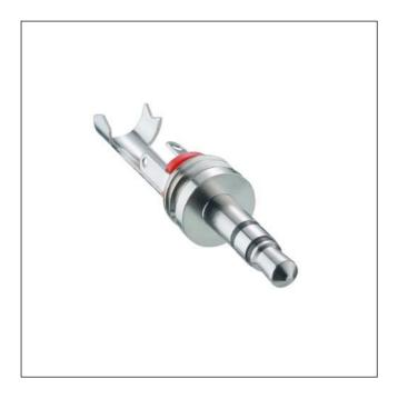
Klinkensteckereinsatz nach JIS C 6560 JC35P3, 3,5 mm, 3-polig/stereo, gerade Ausführung, mit Lötanschlüssen
