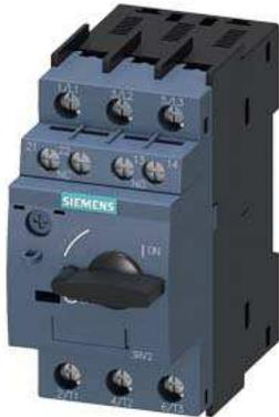
Leistungsschalter Baugröße S00 für den Trafoschutz A-Auslöser 0,45...0,63 A N-Auslöser 13 A Schraubanschluss Standardschaltvermögen mit querliegenden Hilfsschalter 1S+1Ö
