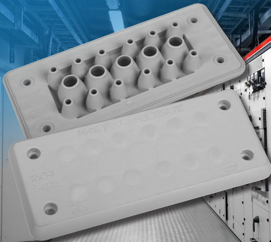
Multigate MH16 F 17-1 ist eine neue kunststoffverstärkte Kabeldurchführung die für verschiedene Kabel, Leitungen und Schläuche entwickelt worden ist. Die Baureihe 16 ist für die Ausbrüche geeignet, welche auch für 16-polige Industrie Steckverbinder vorgesehen sind.
