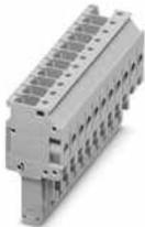
Stecker, Nennspannung: 800 V, Nennstrom: 32 A, Polzahl: 11, Anschlussart: Schraubanschluss, Bemessungsquerschnitt: 4 mm<sup>2</sup>, Querschnitt: 0,2 mm<sup>2</sup>- 6 mm<sup>2</sup>, Farbe: grau
