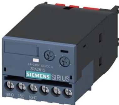
Elektronisch zeitverzögerter Hilfsschalter, rückfallverzögert, ohne Steuersignal, Relais: 1 W, Zeitbereich 0,05-100 s, AC/DC 24-240 V, 50/60 Hz, Varistor zur Bedämpfung der Schützspulen integriert, Schraubanschluss, frontseitig aufschraubbar auf Schütze 3RT2 und Hilfsschütze 3RH2
